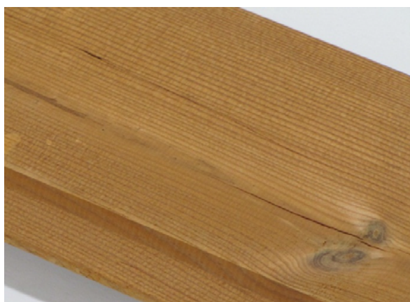
Malé pozdĺžne trhliny na povrchu sú povolené.
